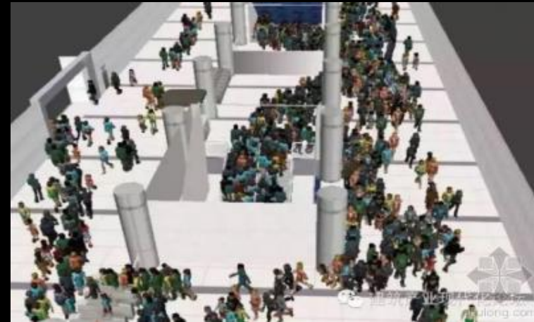
枢纽项目内部人流组织仿真 Internal flow simulation
